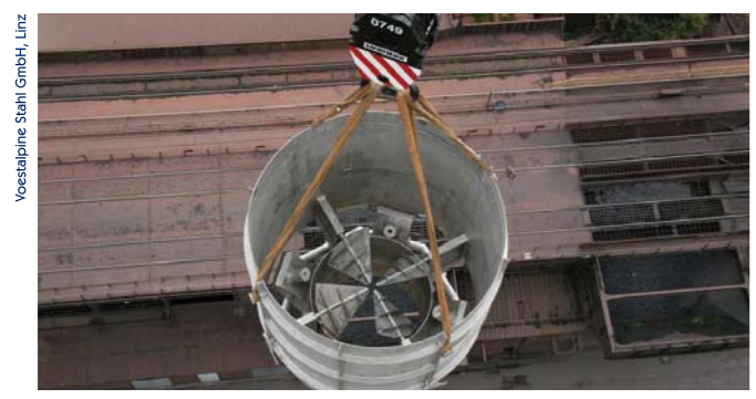
Fackelkopf mit Drallapparat und Zündbrennern
